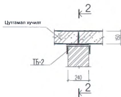
24см-ын хамар ханыг хүчилтанд бэхлэх байдал ТБ-2
