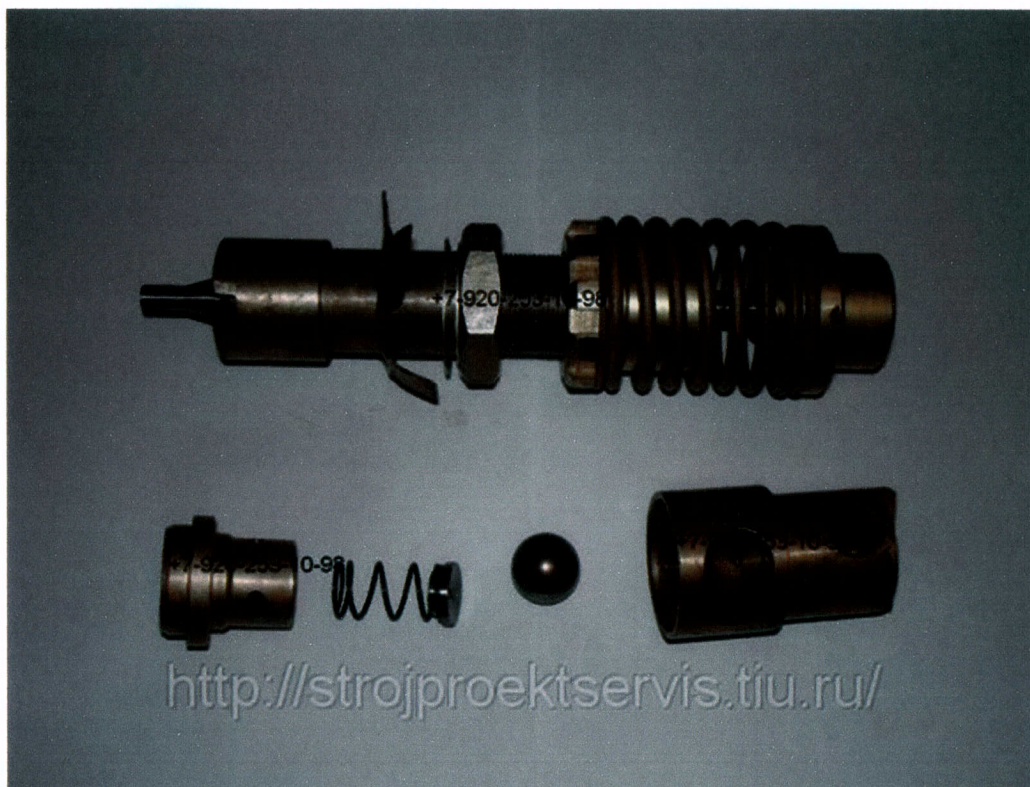
1. Клапан впуска СВ2112 С604А Орох клапан
