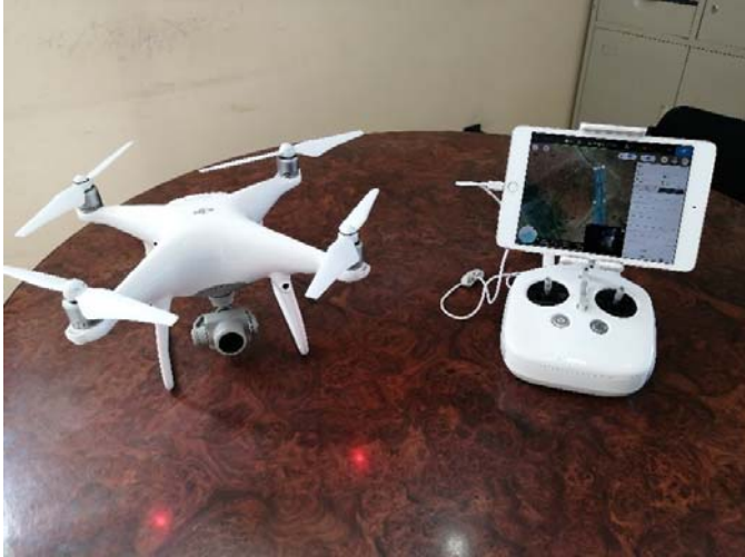
Зураг 1.3 DJI phantom 4 pro ННТөхөөрөмж Нэг нислэгийн хамрах хүрээг DJI phantom 4 pro ННТ-өөр нислэгийг 90 метрийн өндөрт, хөндлөн болон босоо давхцалыг 75 хувиар төлөвлөгөөг хийсэн болно.
