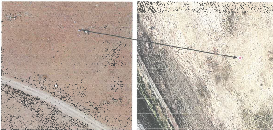
Зураг 7 Зураг авахад ашигласан байрлал, өндрийн үндэслэлийн таних тэмдэг
