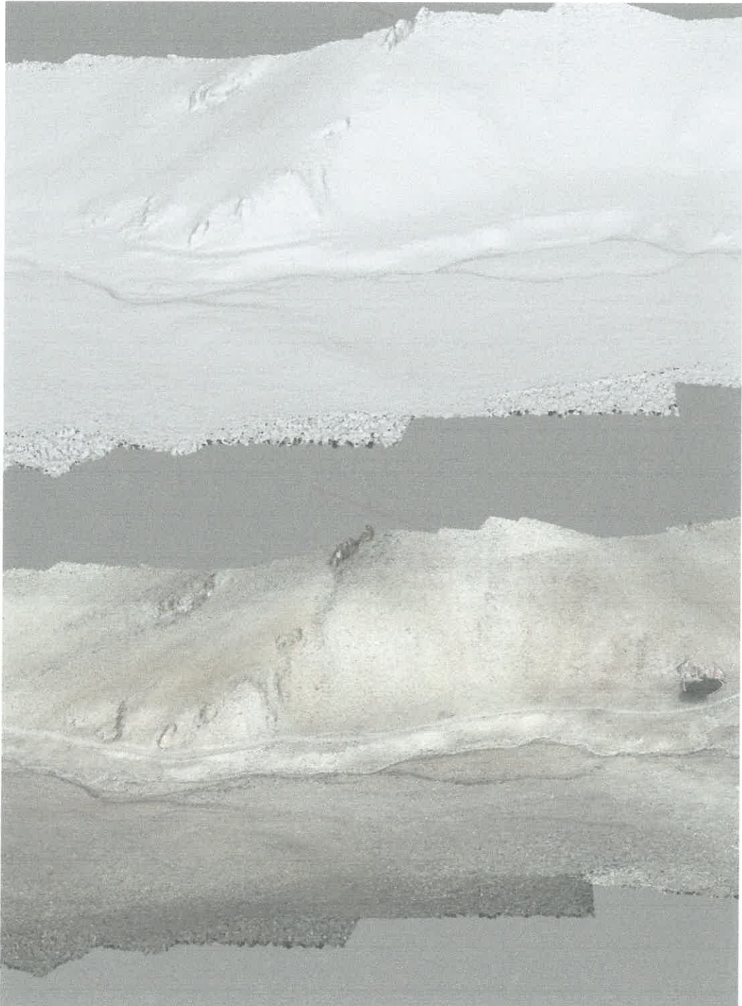
Зураг 8. Агаарын зургийн боловсруулалтын үр дүнд газрын гадаргуугийн өндрийн тоон загвар гаргасан байдал
