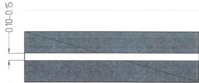
1.1 Замын аюул бүхий хэсэгт эгнээний хилийг тэмдэглэх, Зорчих хэсгийн орахыг хориглосон хэсгийн хилийг тэмдэглэх
