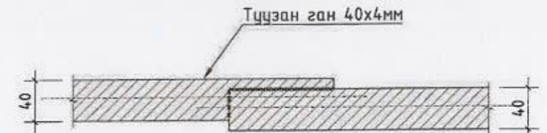
ХЭСЭГЛЭЛ-2 ГАЗАРДУУЛГЫН ХЭВТЭЭ ЭЛЕКТРОДЫН ХОЛБОЛТ
