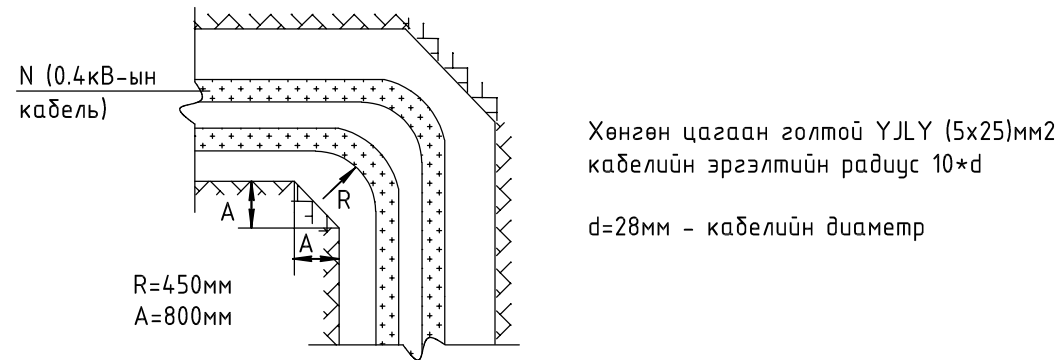
0.4 кВ-ын кабель шугам бохир усны шугамтай зэрэгцэн дайрлах
