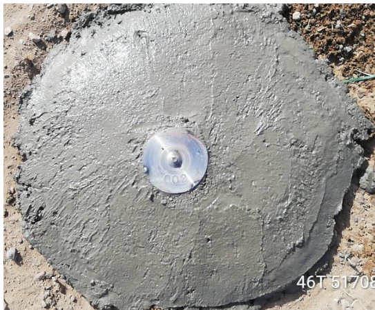
Зураг 4. Шинээр суулгасан цэгүүдээ хамруулан статик хэмжилт хийж байна.
