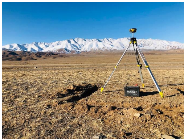
Зураг 4. Шинээр суулгасан цэгүүдээ хамруулан статик хэмжилт хийж байна.
