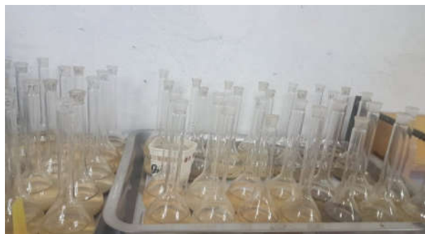
/Лабораторийн нөхцөлд хувийн жинг тодорхойлж байгаа нь/
