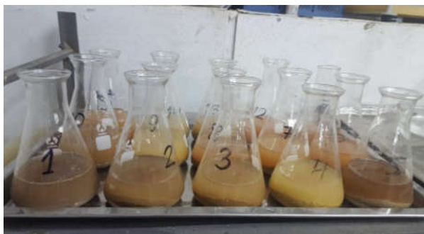
/Лабораторийн нөхцөлд хувийн жинг тодорхойлж байгаа нь/
