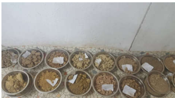
/Фото. Ширхэгийн бүрэлдэхүүн болон шаварлаг хэсгийн фракцын туршилт хэмжилт хийж байгаа нь/
