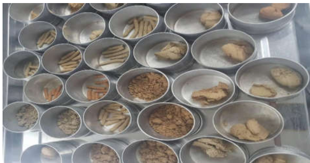
/Лабораторийн нөхцөлд уян налархайн туршилт хийж байгаа нь/
