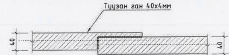
ХЭСЭГЛЭЛ-2 ГАЗАРДУУЛГЫН ХЭВТЭЭ ЭЛЕКТРОДЫН ХОЛБОЛТ
