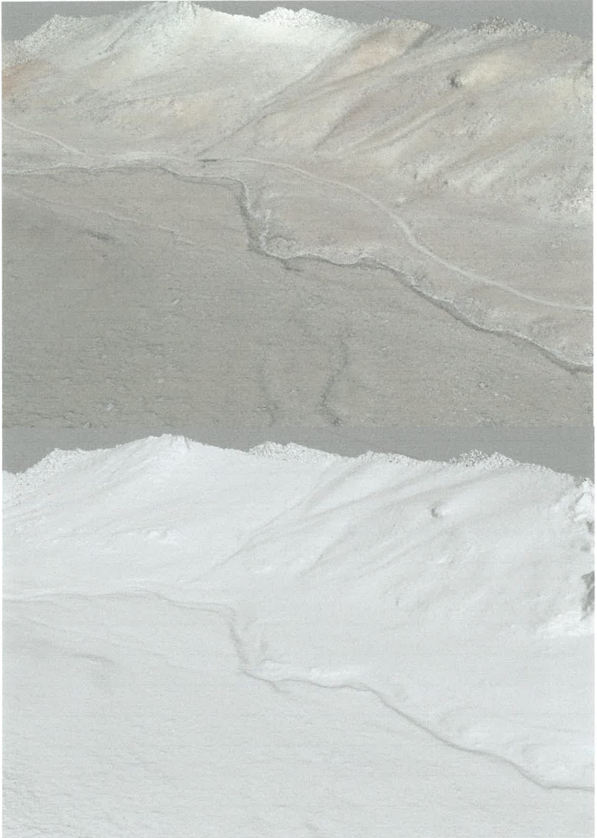
Зураг 8. Агаарын зургийн боловсруулалтын үр дүнд газрын гадаргуугийн өндрийн тоон загвар гаргасан байдал
