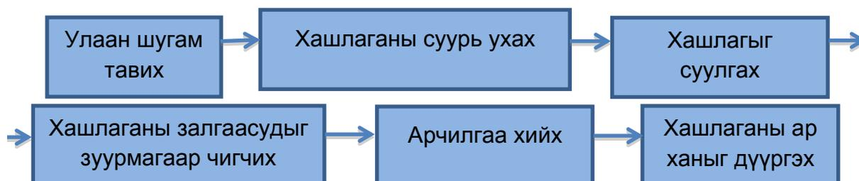
Замын хашлагын ажлыг хийхээс өмнө хашлаганы байрлалд авто замын тэнхлэгтэй параллелиар чиг шугам татах бөгөөд шулуун хэсэгт 10 м-ээс ихгүй, тойруу хэсэгт 5-м-ээс ихгүй, уулзвар гарцтай хэсэгт 1-5 м-ээс ихгүйгээр байхаар гадаслана.
