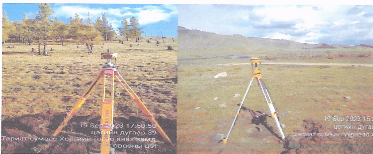
Зураг 4. Шинээр суулгасан болон судалсан цэгүүдээ хамруулан статик хэмжилт хийж байгаа нь
