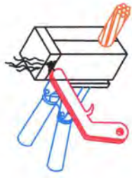
Алхам 4. 0ч газнагчар дарилж асана. Газнагч нунтаг да металл диск бүрэн хойлж, хэбэнд орж зэрцэх хүртэл хүлээ.
