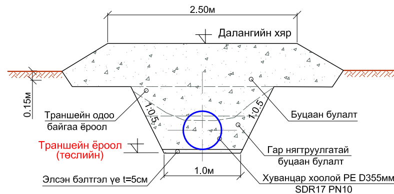
Хагас ухлага-хагас овоолгонд баригдах ус татах далд хоолойн нэг загварын хөндлөн огтлол Масштаб 1:40
