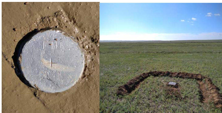
Зураг 3.3. Шинээр суулгасан цэгийн хол ойроос харагдах байдал
