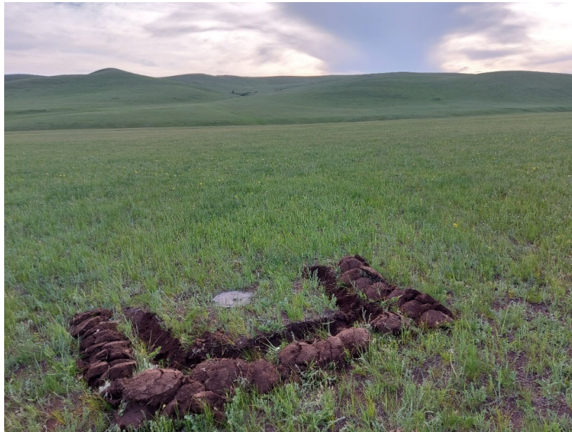
Зураг 2.2.6.1 Геодезийн цэг тэмдэгтийн гаднах тэмдэглэгээ
