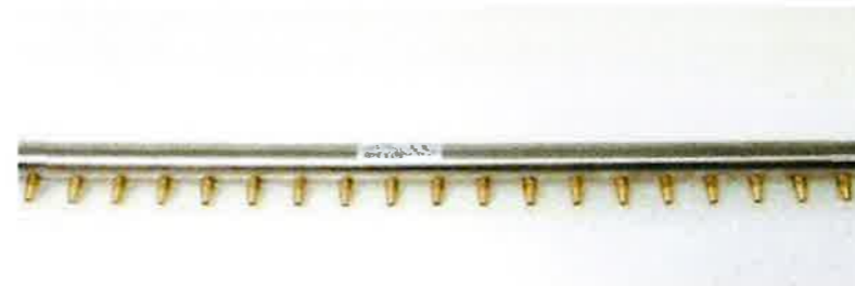
Мананцар үүсгэгч толгой, хоолой нь нерж байх ба усан оргилуурын тойрог хэлбэрийн нерж их биед гагнагдсан байна.
