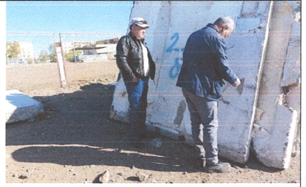
11,12-р зураг. Угсармал эдлэлийн бетоны бат бэхийг ойлтын багажаар шалгаж байна.
