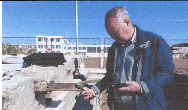
11,12-р зураг. Угсармал эдлэлийн бетоны бат бэхийг ойлтын багажаар шалгаж байна.
