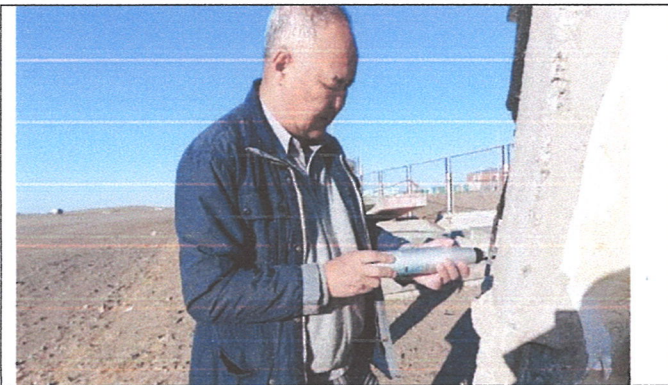
9,10-р зураг. Угсармал бүтээцийн бетоны бат бэхийг Шмидтийн шалгаж байна
