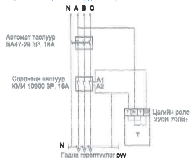
Унтрааж асаах цагийн тохируулгатай релений холболтын схем
