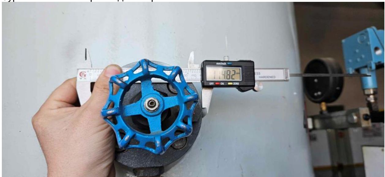
Зураг 5. Хаалтны гадна диаметр
