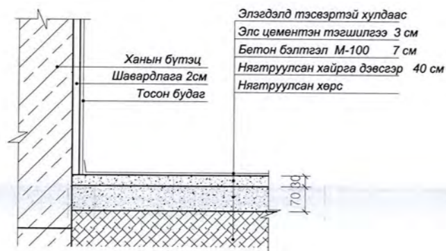
Бетон шал, хулдаас
