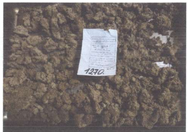
Фото зураг № VI-15,VI-16 Судалгааны талбайд өрөмдсөн цооногуудад илэрсэн бор саарал өнгөтэй хайргатай, тоосорхог шаварлаг ЭЛС үл хөрс. Пикет ПК4+500 цооног Ц-14 дээж авсан гүн-1,0м
