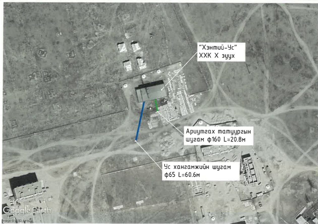
УХАТ-ын гадна шугамын бүдүүвч M1:250
