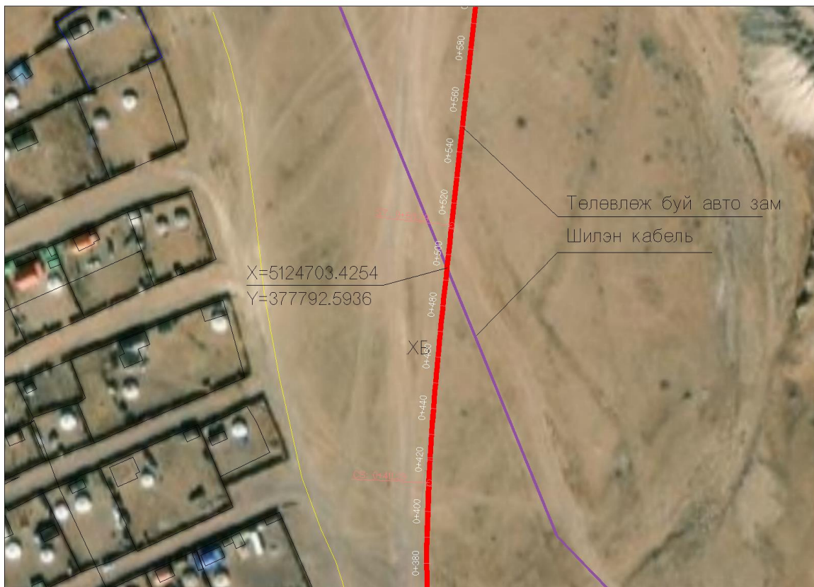
Зураг 2. Авто замын дагууд дайрч буй инженерийн байгууламж
