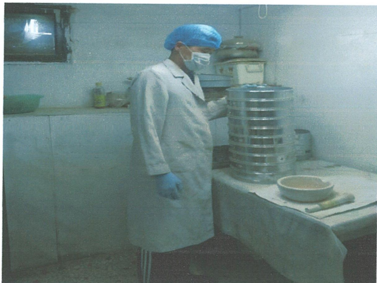
Фото зураг 5 Лабораторид хөрсний том хэсгийн ширхэгийн бүрэлдэхүүнийг шигшүүрийн аргаар тодорхойлж байгаа нь
