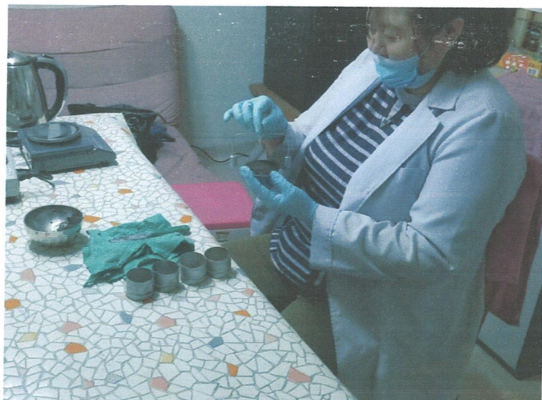
Фото зураг 6 Лабораторид хөрсний урсалтын хязгаар дээрхи чийгийг Васильевийн конусаар тодорхойлж байгаа нь
