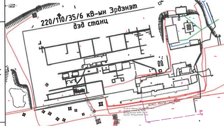
35 кВ-ын Котель ЦДАШ-ын 1-8-р тулгуур хоорондох АС-150/24 маркийн дамжуулагчийг АСМСС-150/30 маркийн дамжуулагчаар солих
