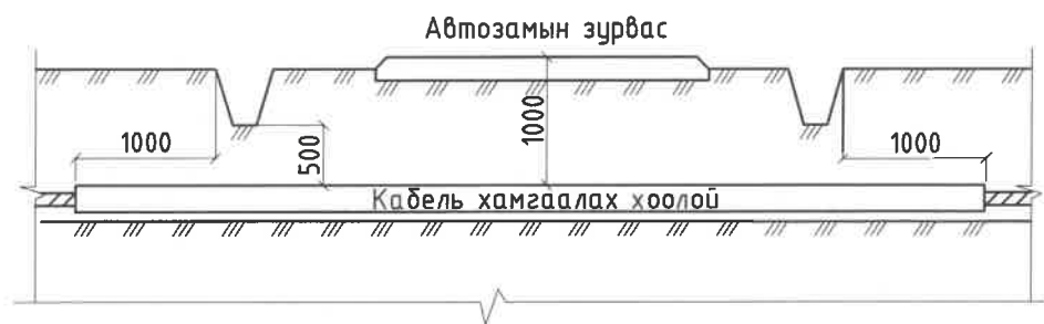
Хувилбар 1. Ус зайлуулах суваг байгаа, хамгаалалтын зурвас байхгүй үед
