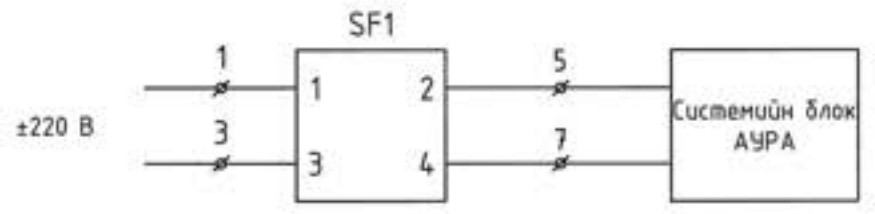
«АУРА» -төхөөргийн тэжээлийн холболтын схем ±220 В.
