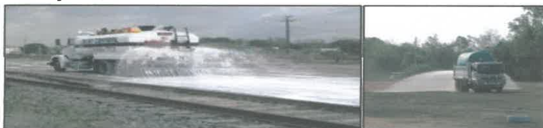
Зураг 78. 16 тн-ны багтаамжтай тоосжилт дарах усалгааны автоцистерн
