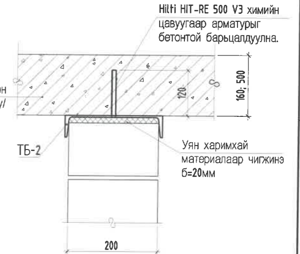
Хучилт, дамнуруунд хамар хана бэхлэх байдал M1:10
