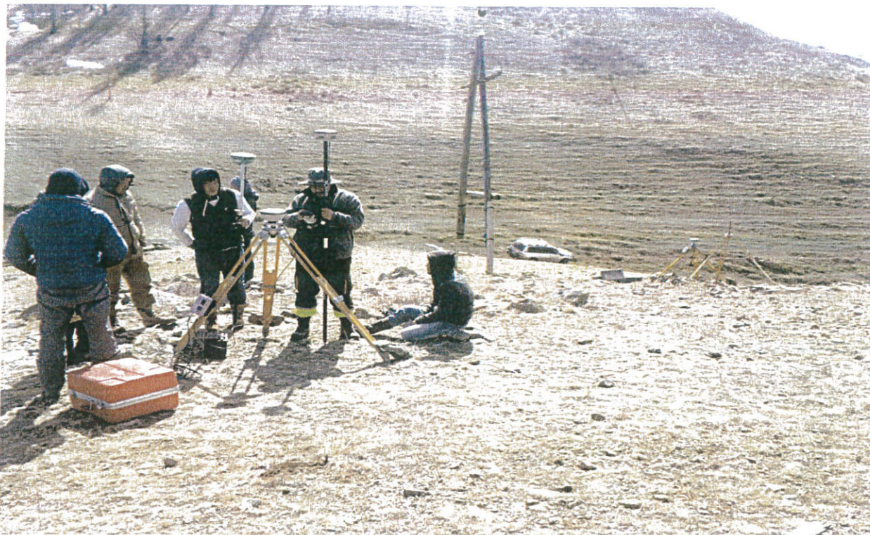
GPS-н сүлжээний цэг дээр багаж суурьлуулж буй байдал.
