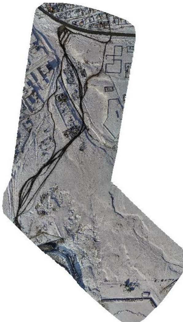
Зураг 8 Морингийн зам орчимд хийсэн PIX 4D mapper программ дээр боловсруулсан орто зураг
