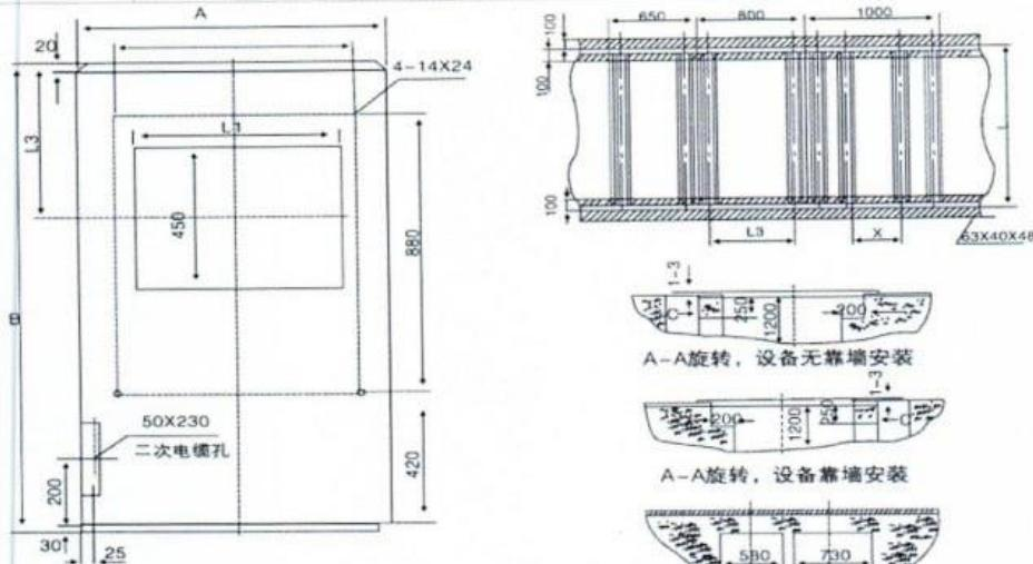
图6开关设备安装示意图
