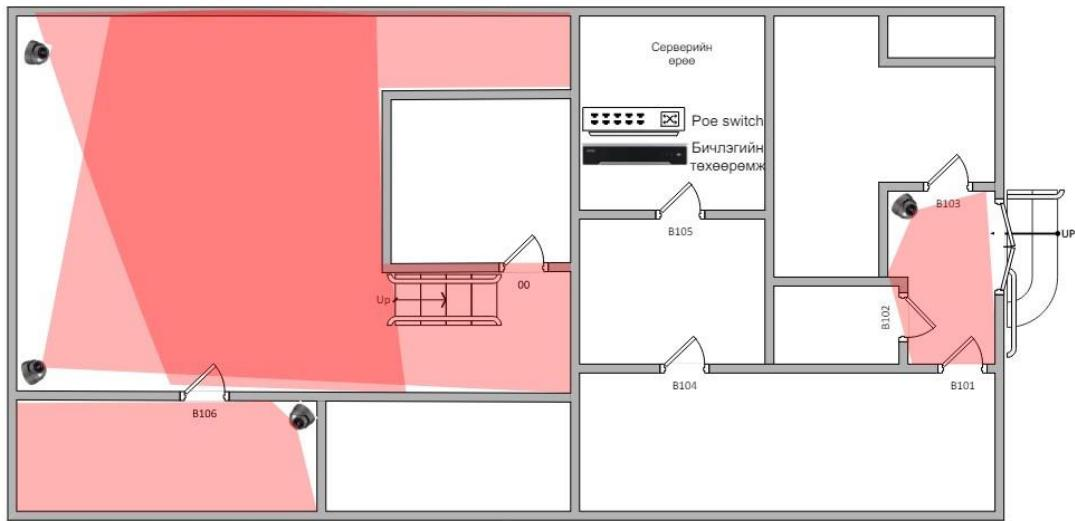
Тайлбар: Газар доорх 1-р давхарт байрлах серверийн өрөөнд хяналтын камерийн бичлэгийн төхөөрөмж болон пое свичийг сууринуулан камераудыг холбон тоноглох
