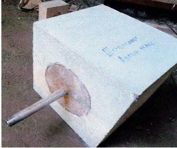
АРГОНЫ МАССЫН ЗУРАГ ASSEMBLED PURGING PLUG, SEATING BLOCK'S PICTURE
